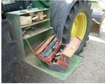
Boite de rangement intégrée au tracteur avec tablette servant de mini atelier. Permet de ne pas mettre le matériel dans la cabine et facilite l'accès aux différents outils.
